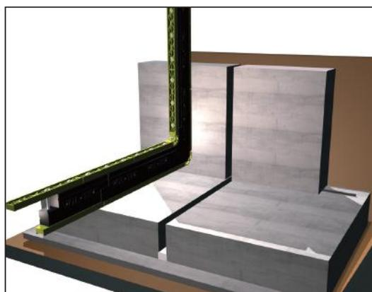
Inserire nell'alloggiamento così creato, il profilo espansivo VOL-TEC, provvedendo alla regolarizzazione della tensione del corpo in gomma stringendo i bulloni del profilo superiore con un normale avvitatore.
