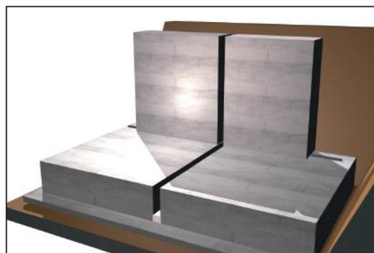
Procediamo con il getto della seconda porzione di platea. La dima andrà rimossa per ottenere la sede perfetta per l'inserimento del giunto espansivo VOL-TEC.
